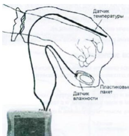
Рис. 17. Схема экспериментальной установки терморегуляции кожи
