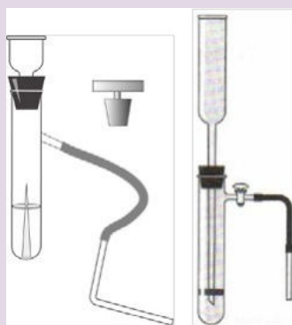
Рис. 7. Прибор для получения и собирания газов
