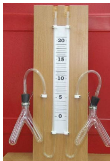
Рис. 19. Прибор для определения скорости химических реакций
