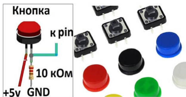
Рис. 1. Схема подключения тактовой кнопки к микроконтроллерной плате
